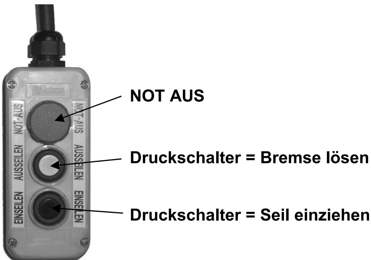
Zum Einziehen des Zugseiles ist der schwarze Knopf zu drücken. Wird dieser los gelassen, bleibt die Seitrommel stehen und bremst automatisch ein (=Totmannschaltung). Zum Seil ausziehen ist der weiße Knopf ca. 3-4 sek. lang zu drücken, um die Bremse vollständig zu öffnen. Kurzes Antippen des weißen Knopfes öffnet die Bremse langsam.
