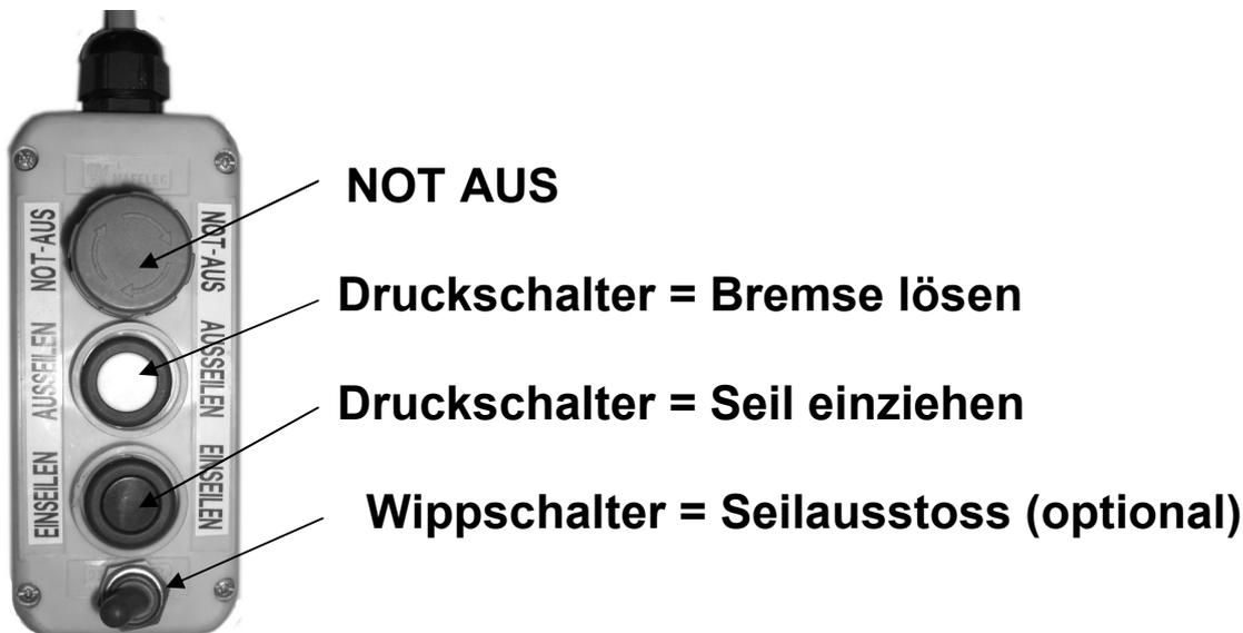
Zum Seil ausziehen, ohne Seilausstoss, ist der weiße Knopf ca. 3-4 sek. lang zu drücken, um die Bremse vollständig zu öffnen. Kurzes Antippen des weißen Knopfes öffnet die Bremse langsam. Kurzes Antippen des schwarzen Knopfes (Einseilen) schließt die Bremse wieder. Zum Einziehen des Zugseiles ist der schwarze Knopf zu drücken. Wird dieser los gelassen, bleibt die Seiltrommel stehen und bremst automatisch ein (=Totmannschaltung).
