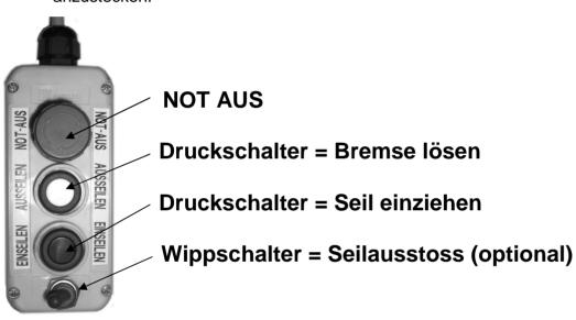
Das Seil wird mittels Seilausstoss ausgespult. Durch betätigen des Wippschalters öffnet sich die Bremse und das Zugseil wird mittels Motor ausgestossen. Gestoppt wird der Seilausstoss durch Umlegen des Wippschalters.
